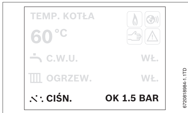
Rys. 5 Odczytanie ciśnienia roboczego
